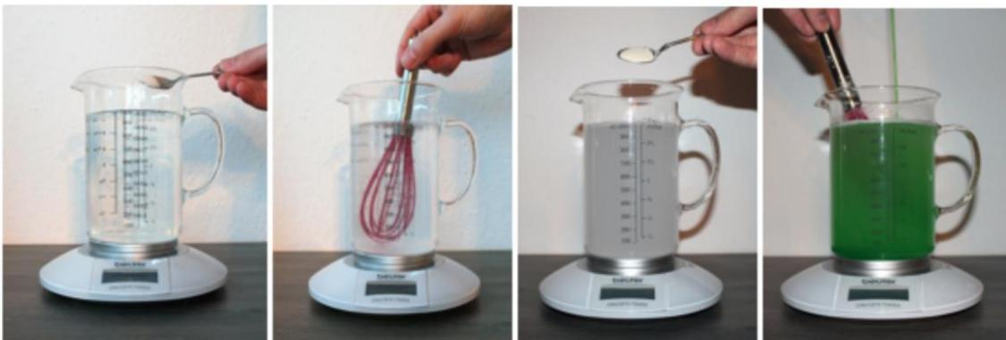
1. Zuerst **0,5 gr Kleister** in 1 Liter kaltes Wasser gut einrühren und 20 min warten. Anschließend nochmal gut umrühren.
